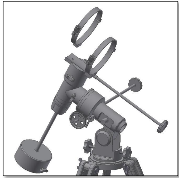
Fig. 5. Montage et serrage des colliers.
