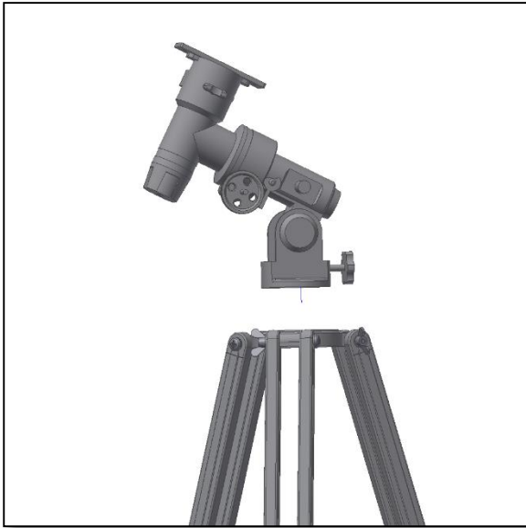
Fig. 4. Mise en place de la monture équatoriale.
